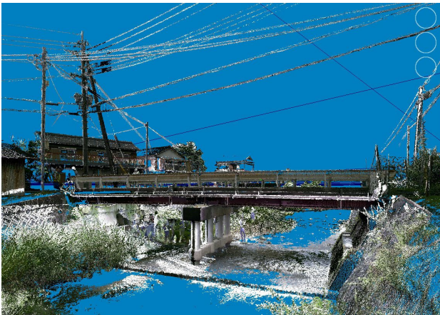
図-6 大荒田橋 橋梁形状復元図
