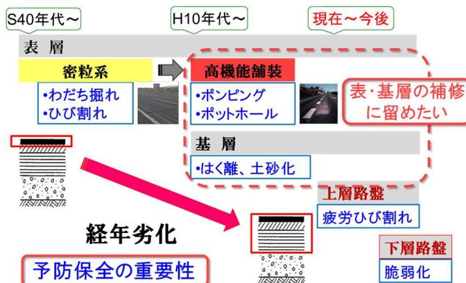
図-2 舗装損傷の深層化
