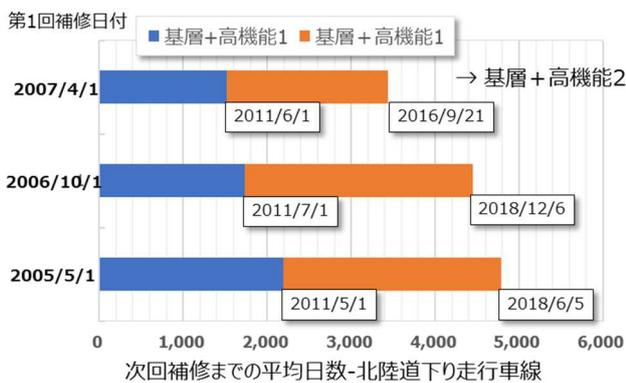
図-12 補修パターン(2層→2層→2層)の耐用日数
