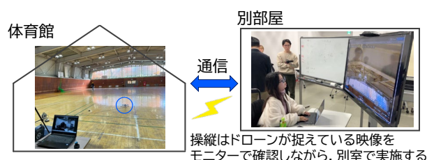
図-7 遠隔によるドローン操縦
